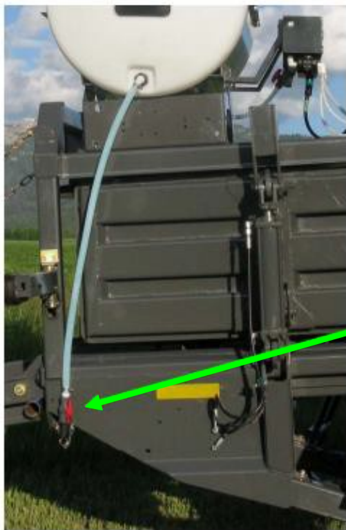
Linea di scarico/riempimento sulla pressa
