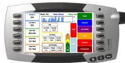
La serie 700 offre la possibilità di effettuare l'integrazione con la pressa VT. Ciò consente all'operatore di monitorare in tempo reale sia le impostazioni della pressa reale che i parametri del sistema Harvest Tec su un unico schermo e ottenere la massima precisione di applicazione per ogni balla.
